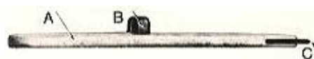
A.- Mango. B.- Tope de introducción del útil. C.- Extremo del caucho para quitar las motas de polvo o papel
